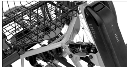
Abb.:23 1 Luftfederung am Rahmen (exemplarisch)
